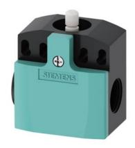
Positionsschalter mit erhöhtem Korrosionsschutz Kunststoffgehäuse 50mm, Geräteanschluss 2 x (M20 x 1,5) 1S/1Ö Schleichkontakte, Kuppenstößel
