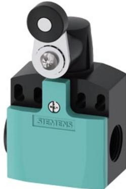
Positionsschalter Kunststoffgehäuse 50mm, Geräteanschluss 2 x (M20 x 1,5) 1S/1Ö Schleichkontakte, Schwenkhebel mit Kunststoffrolle 19 mm
