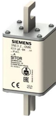
SITOR-Sicherungseinsatz, mit geschlitzten Messerkontakten, NH1, In: 50 A, gR, Un AC: 1000 V, Un DC: 600 V, Stirnkennmelder
