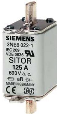
SITOR-Sicherungseinsatz, mit Messerkontakten, NH00, In: 125 A, aR, Un AC: 690 V, Un DC: 440 V, Stirnkennmelder
