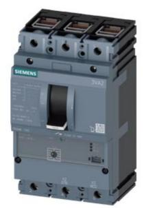
Interruttore automatico 3VA2 IEC Frame 160 Classe del potere di interruzione C Icu=110kA @ 415V a 3 poli, protezione avviatore ETU310M, I, In=63A protezione da sovraccarico Ir=25A...63A protezione da cortocircuito Ii=3...15 x In connessione a morsetto bobina a lancio di corrente (STL) 110 ... 127V DC, AC 50/60Hz 2 blocchetti di contatti ausiliari HQ 1 contatto di segnalazione intervento HQ 1 blocchetto di contatti di segnalazione intervento di protezione
