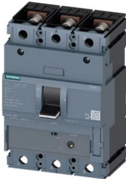
Interruttore automatico 3VA1 IEC Frame 250 Classe del potere di interruzione H Icu=70kA @ 415V a 3 poli, protezione avviatore TM120M, AM, In=200A senza protezione da sovraccarico protezione da cortocircuito Ii=6 ... 14 x In attacco piatto a vite 2 blocchetti di contatti ausiliari HP
