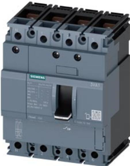
interruttore automatico 3VA1 IEC frame 100 classe del potere di interruzione S Icu=36kA @ 415V a 4 poli, protezione impianto TM210, FTFM, In=80A protezione da sovraccarico Ir=80 A con regolazione fissa protezione da cortocircuito li=10 x In conduttore di neutro non protetto attacco piatto a vite bobina di minima tensione (UVR) AC 208-230 V 50/60 Hz 2 blocchetti contatti aus. HQ
