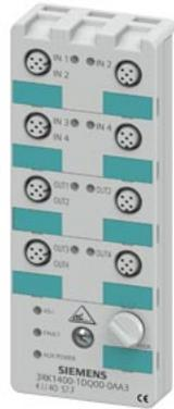
AS-i Kompaktmodul K60 digital 4DI/4DQ, IP67 4 x Eingang, maximal 200 mA 4 x Ausgang, 2 A, DC 24 V maximal 4 A für alle Ausgänge 8 x M12-Buchse Y-II-Belegung Montageplatte 3RK1901-0CA00 ist separat zu bestellen
