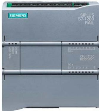
SIPLUS S7-1200 CPU 1212C DC/DC/DC T1 RAIL based on 6ES7212-1AE40-0XB0 mit Conformal Coating, -25...+60°C, OT1 mit ST1/2 (+70°C für 10min), Kompakt-CPU, DC/DC/DC, onboard I/O: 8 DI 24V DC 6 DO 24V DC 2 AI 0-10V DC, Stromversorgung: 20,4-28,8V DC Programm-/Datenspeicher 50 KB
