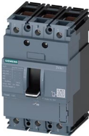
Interruttore automatico 3VA1 IEC Frame 100 Classe del potere di interruzione B Icu=16kA @ 415V a 3 poli, protezione impianto TM210, FTFM, In=100A protezione da sovraccarico Ir=100 A con regolazione fissa protezione da cortocircuito li=10 x In connessione a morsetto bobina a lancio di corrente (STL) 110 ... 127V DC, AC 50/60Hz
