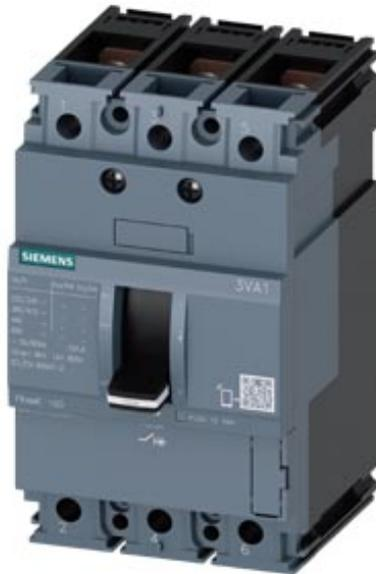
Interruttore automatico 3VA1 IEC Frame 100 Classe del potere di interruzione N  $I_{cu}=25kA @ 415V$  a 3 poli, protezione impianto TM210, FTFM,  $I_n=100A$  protezione da sovraccarico  $I_r=100 A$  con regolazione fissa protezione da cortocircuito  $I_i=10 \times I_n$  attacco piatto a vite bobina di minima tensione (UVR) AC 120 ... 127 V 50/60 Hz 2 blocchetti di contatti ausiliari HQ
