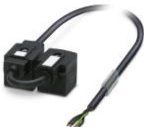
Cavo per doppio connettore per valvole, 4-poli, PUR/PVC, nero, estremità conduttore libera, su Connettore per valvole A, con 1 LED, collegato con Diodo Z e Connettore per valvole A, con 1 LED, collegato con Diodo Z, lunghezza cavo: 5 m, distanza connettori per valvole: 0,15 m
