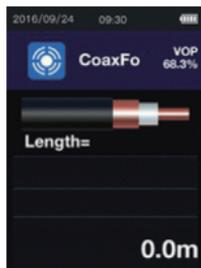
Selezionare "Coaxial cable" come tipo di cavo collegato per la prova.
