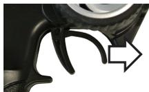
→ Non passare immediatamente da una direzione di marcia all'altra, ma arrestare prima il veicolo prima di procedere in un'altra direzione. Passare direttamente a un'altra direzione di marcia può sovraccaricare la trasmissione.
