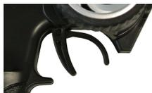
2. Procedere con la marcia avanti, tirare lentamente la leva dell'acceleratore/freno in direzione dell'impugnatura
