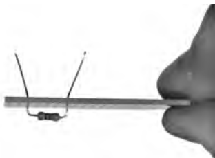
Foto 33: Affinché i componenti inseriti dal basso non cadano durante la saldatura, i loro fili di collegamento devono essere leggermente piegati lateralmente.
