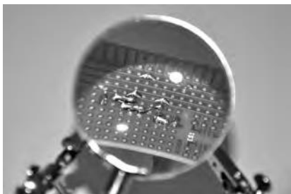
Foto 32: Le saldature eseguite correttamente brillano e hanno una superficie liscia.
