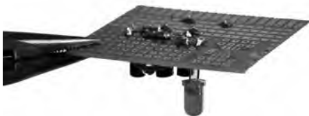
Foto 63: I cavi di collegamento devono essere tagliati appena sopra i coni a saldare.
