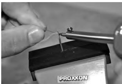
Foto 26: Il filo attorcigliato deve essere riscaldato e si deve aggiungere della lega saldante che si scioglie immediatamente.
