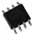
Foto 16: Il PIN 1 dell'SMD-IC è contrassegnato da un punto sul lato superiore dell'alloggiamento.
