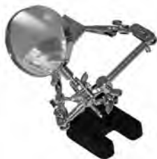
Foto 20: La "terza mano", con lente di ingrandimento mantiene in posizione anche il circuito stampato.
