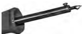
Foto 23: Nel corso del tempo, la saldatura si accumula sulla punta di saldatura, rendendo molto più difficile un'ulteriore saldatura.
