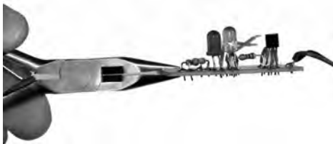
Foto 62: Le connessioni pizzicate devono sporgere di 0,5-1 mm oltre la scheda.
