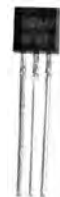
Foto 11: Transistor con vista sul lato appiattito; Connessioni da sinistra a destra: collettore (C), base (B) ed emettitore (E)
