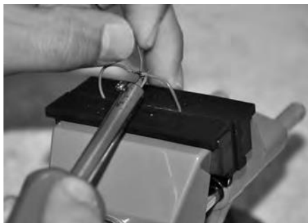
Foto 27: Poiché l'isolamento si scioglie rapidamente, la saldatura dei fili deve essere effettuata rapidamente.
