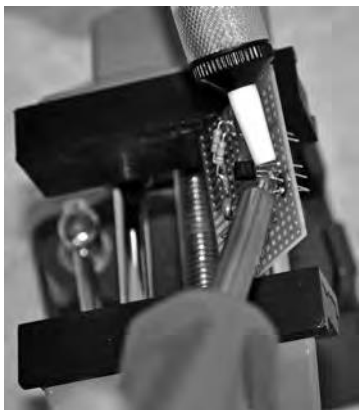
Foto 57: I grumi di saldatura possono essere rimossi riscaldando e aspirando con la pompa di dissaldatura..
