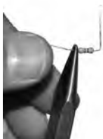
Foto 29: Per i componenti elettrici, i fili non devono essere piegati direttamente all'estremità dell'alloggiamento.
