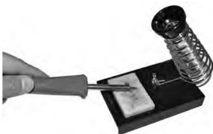
Foto 24: Per questo motivo, le impurità devono essere rimosse regolarmente su una spugna umida, o su una paglietta metallica morbida.
