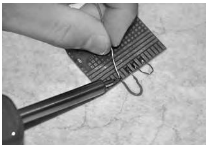
Foto 30: Saldatura di ponti metallici al PCB
