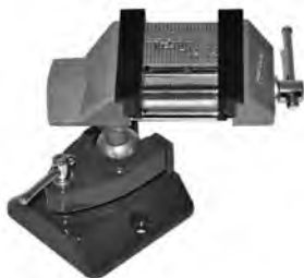
Foto 19: La morsa di precisione è ideale per il serraggio e la comoda saldatura dei PCB..
