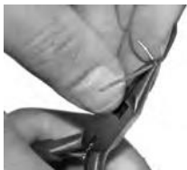
Foto 28: Il filo è piegato a misura con una pinza elettronica a becchi tondi.
