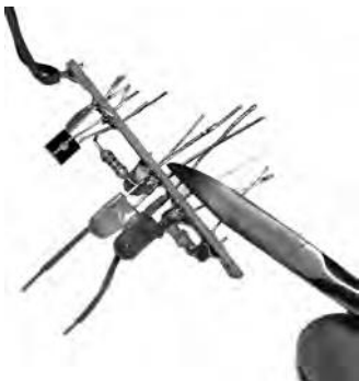
Foto 61: Le lunghezze in eccesso dei cavi di collegamento devono essere tagliate con un tronchesino per elettronica dopo che il circuito è stato completato e controllato.
