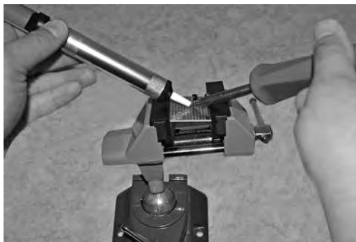
Foto 65: La dissaldatura funziona solo con la pompa di aspirazione.
