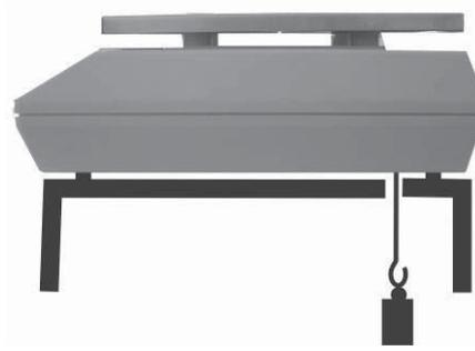
Fig. 1: Preparazione della bilancia per pesature a ponte
