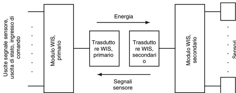
La somma delle correnti di riposo di tutti i sensori collegati sul lato secondario al modulo WIS non deve superare il valore massimo della corrente trasferibile. Tale valore può essere calcolato sulla base della potenza trasferita fornita dal trasduttore / 12 V.
