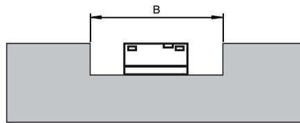
Per evitare che le caratteristiche dei trasduttori vengano modificate è necessario rispettare la distanza dalle pareti metalliche indicata per i due trasduttori WIS che va al di là dello spazio libero minimo.
