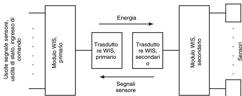
La somma delle correnti di riposo di tutti i sensori collegati sul lato secondario al modulo WIS non deve superare il valore massimo della corrente trasferibile. Tale valore può essere calcolato sulla base della potenza trasferita fornita dal trasduttore / 12 V.
