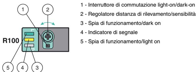
Per sbloccare le funzioni di regolazione ruotare il regolatore distanza di rilevamento/sensibilità oltre i 180 gradi.
