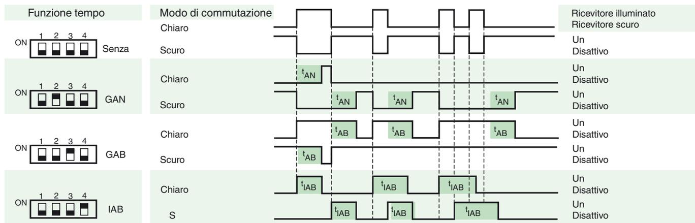
i tempi  $t_{AN}$ ,  $t_{AB}$  e  $t_{IAB}$  sono regolabili tra 0,1 s e 10 s
