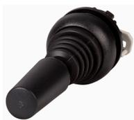
**joystick, con un punto di commutazione per ogni direzione di azionamento, con asse in materiale isolante, 2 posizioni, Anello frontale colore nero, ad impulso, Orizzontale**
