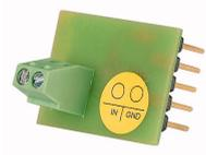
**Modulo d'adattamento, per sensore di fumo**
