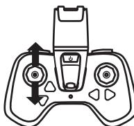
Dźwignia przepustnicy może być również używana do obracania drona o 360 stopni w lewo lub w prawo. Innymi słowy, można zmienić usytuowanie drona, aby był skierowany w różnych kierunkach.
