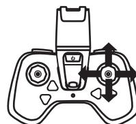
Przesuń dźwignię sterowania w prawo, aby przesunąć dron w prawo.
