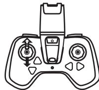
Naciśnij dźwignię przepustnicy (8) w góre (usłyszysz sygnał dźwiękowy), a następnie pociągnij ją w dół. Po pomyslnym sparowaniu zabrzmi kolejny sygnał dźwiękowy, a diody LED na dronie i module zdalnego sterowania pozostaną na stałym poziomie.
