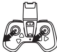
Przed pierwszym lotem i zawsze, gdy dron wydaje się być niewyważony w locie, można zresetować żyroskop za pomocą modułu zdalnego sterowania. Pociągnij przepustnicę i dźwignię kierowniczą pod kątem 45 stopni przez 2 do 3 sekund, a następnie je zwolnij. Żyroskop jest resetowany, gdy migająca dioda LED na dronie zacznie świecić się w sposób ciągły.
