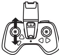
Lorsque la manette de commande de l'accélération est dans la position neutre, le drone plane à une altitude constante. Lorsque la manette est déplacée vers le haut, la vitesse des rotors augmente, ce qui fait monter le drone. Lorsque la manette est déplacée vers le bas, la vitesse des rotors chute, ce qui réduit l'altitude du drone. Nous recommandons de ne pas faire voler le drone à plus de 10 mètres de haut.
