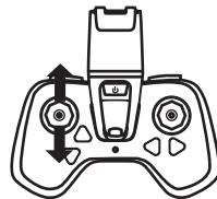
Quando la leva dell'acceleratore è in posizione neutra, il drone staziona a un'altitudine costante. Quando la leva viene spostata verso l'alto, la velocità dei rotori aumenta, il che fa salire il drone. Quando la leva viene spostata verso il basso, la velocità dei rotori diminuisce e l'altitudine del drone si abbassa. Si consiglia di far volare il drone ad un'altezza non superiore a 10 metri.
