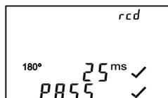
→ Quando si genera una corrente di guasto di 30 mA si dimostra che al raggiungimento della corrente di guasto nominale, scatta l'interruttore differenziale di protezione FI. Se viene superato il valore limite della tensione di contatto massima di 50 V, sul display viene visualizzato il simbolo "UB > 50 V" e il test viene interrotto.
