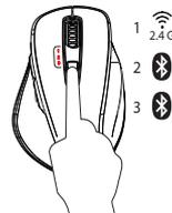
2. L'indicatore luminoso del canale corrispondente lampeggerà per indicare il canale correntemente attivo.
