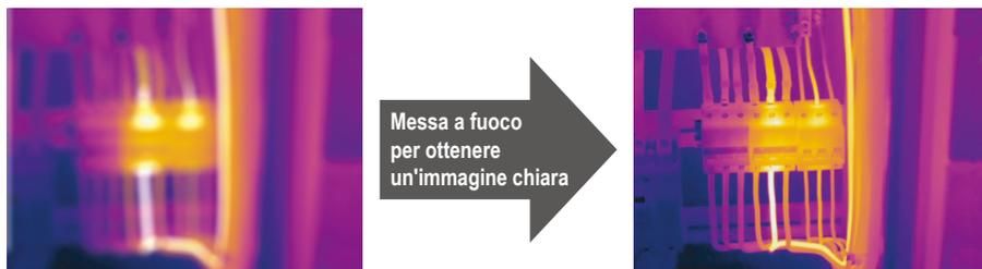
Nota: Una messa a fuoco corretta è importante in tutte le applicazioni di imaging. Una corretta messa a fuoco assicura che l'energia infrarossa sia correttamente diretta sui pixel del rilevatore. Senza una corretta messa a fuoco, l'immagine termica potrebbe risultare sfocata e i dati radiometrici non sarebbero accurati. Le immagini a infrarossi sfocate sono spesso inutilizzabili o di scarso valore.
