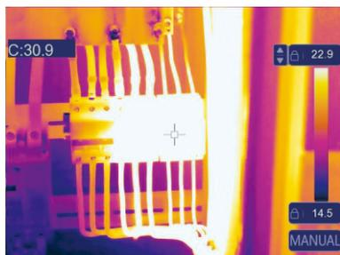
Bloccare il livello alto e regolare il livello basso dell'intervallo di temperatura come segue:
