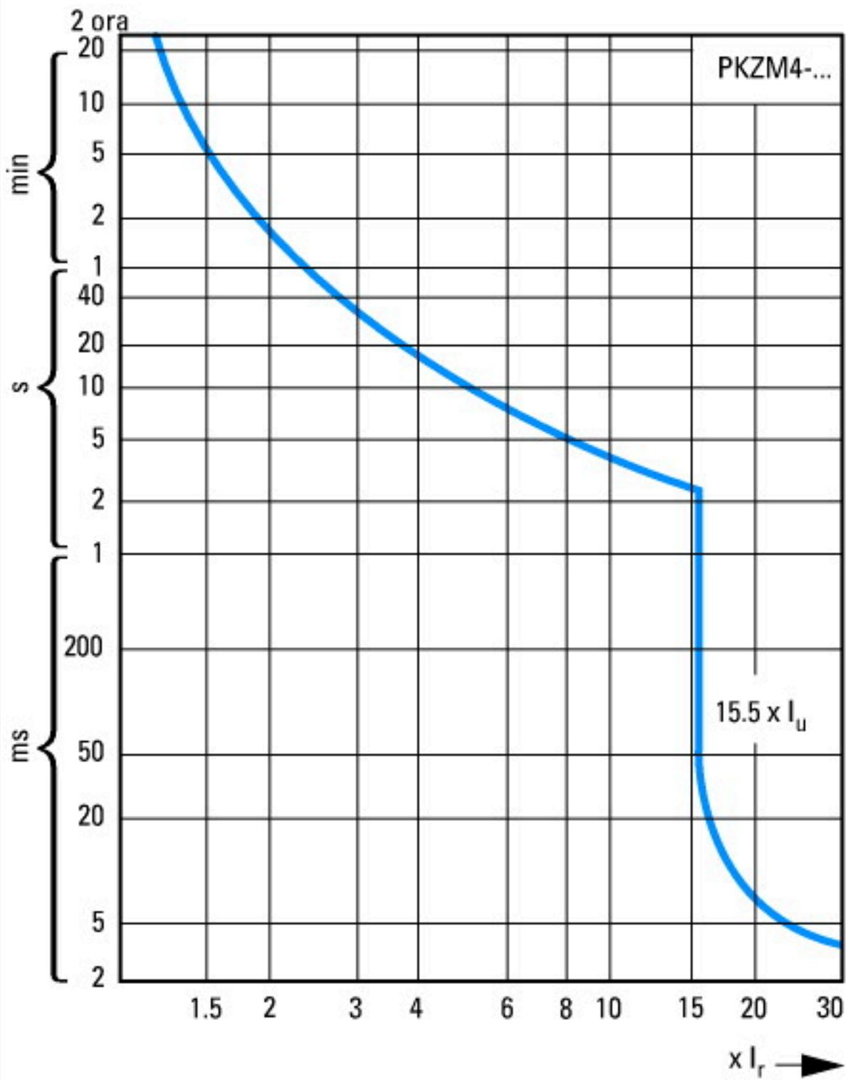
Caratteristiche di sgancio dell'interruttore per la protezione del motore
