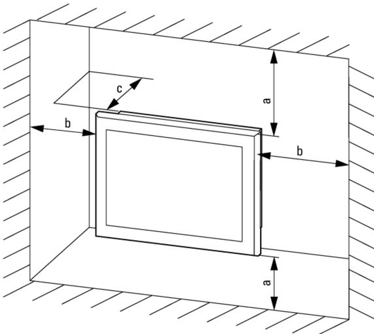
$a, b \geq 50 \text{ mm}$ ,  $c \geq 20 \text{ mm}$ ,  $0 \leq T \leq 50 \text{ }^\circ\text{C}$
