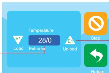
② Quando si tratta della temperatura preimpostata, fare clic su E1, il motore di alimentazione inizia a scaricarsi automaticamente e l'utente può estrarre il filamento.
