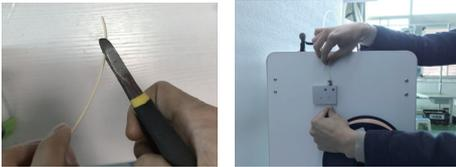
② Inserire il filamento nel tubo fino a quando sono visibili circa 5 cm all'estremità dell'estrusore.
