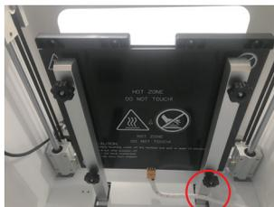
e) Una volta terminati i passi a.b.c.d 4, bisogna ripetere quanto indicato nel paragrafo 3.2.2 per eseguire la calibrazione dell'offset Z, dopodiché si può eseguire l'autolivellamento e iniziare a stampare.
