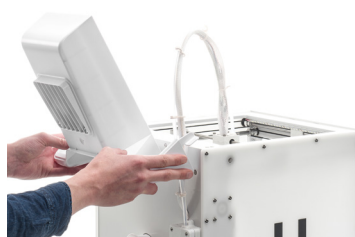
Allineare l'alloggiamento del filtro
