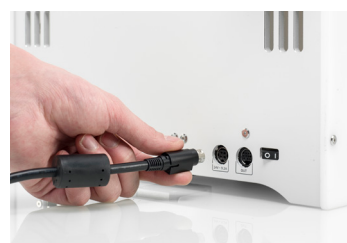
Collegare il cavo di alimentazione
