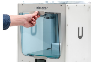
Installare la chiusura frontale
