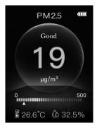
2 Premere nuovamente il pulsante di accensione/spegnimento per visualizzare la schermata 2, che mostra i dati di temperatura e umidità e le concentrazioni di massa del PM2,5 e PM10 (con rappresentazione a 6 colori del livello di qualità dell'aria).
