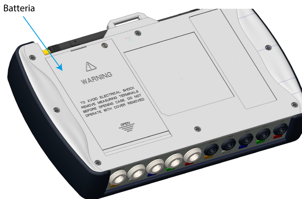
Figura 1: Posizione della batteria.
