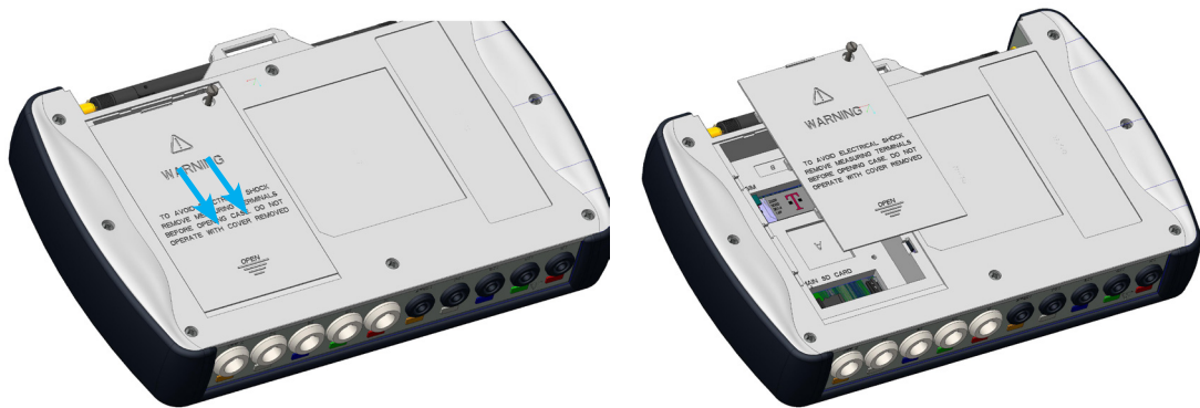
Figura 2: Estrazione dello sportello della batteria.
