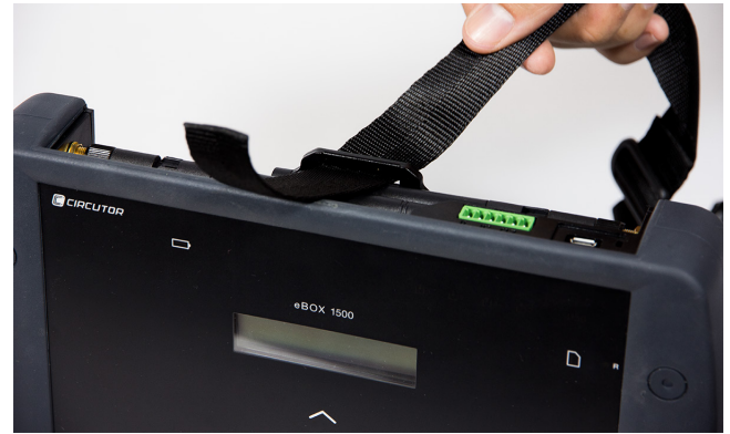
Figura 7: Installazione della cinghia di sicurezza: Passaggi 1 e 2.
