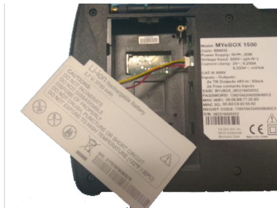
Figura 3: Collegare la batteria.
