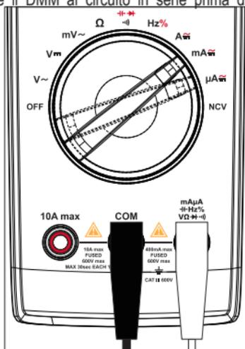
1. Impostare il selettore di funzione su  $\mu$ A $\overline{\sim}$ , mA $\overline{\sim}$ , o A $\overline{\sim}$ , l'unità di misura corrispondente verrà mostrata sul display.
