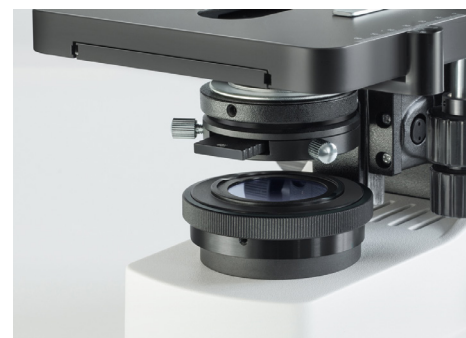
Condensatore a contrasto di fase montato
