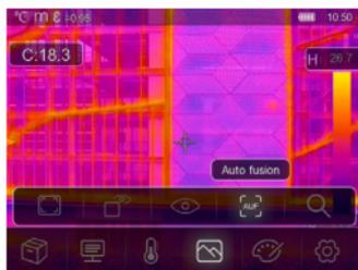
Visualizza un confronto tra la temperatura dell'area centrale e l'immagine completa. L'imager calcolerà automaticamente il rapporto tra le immagini a infrarossi e quelle visibili.
