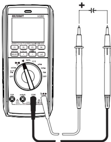
In caso di puntali di misurazione "aperti" può essere visualizzato un valore a causa dell'ingresso di misura sensibile. Premere il tasto "REL" per la misurazione di piccole capacità ( $<600 \text{ nF}$ ). In questo modo il display indica "0". Allo stesso tempo tuttavia viene disattivata la funzione Autorange.
