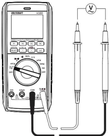
Il campo di tensione "V/CA" presenta una resistenza di ingresso di  $\geq 10\text{ M}\Omega$ .
