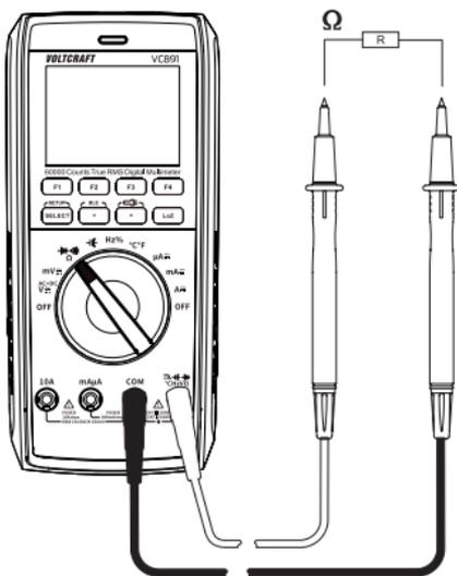
Quando si esegue una misurazione della resistenza, assicurarsi che i punti di misura che entrano in contatto con le punte per la misurazione siano privi di sporcizia, olio, vernice per saldatura o simili. Tali circostanze possono influenzare il risultato della misurazione.
