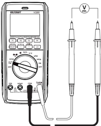
Se appare un “-” per la tensione continua davanti al valore misurato, la tensione misurata è negativa (o i puntali di misurazione sono stati invertiti).
