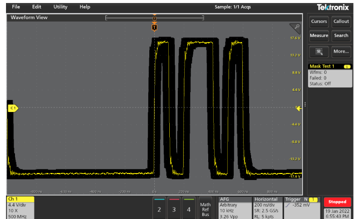
Applicazione di limiti al test delle maschere in base al segnale di riferimento "golden"
