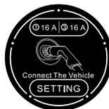
Viene visualizzato sul display se il caricabatterie non è stato collegato al veicolo. Toccare il pulsante SETTING (Impostazione) per accedere al menu delle impostazioni e configurare la sessione di ricarica.
