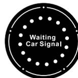
Viene visualizzato sul display se il caricabatterie è collegato al veicolo e sta stabilendo un canale di comunicazione.
