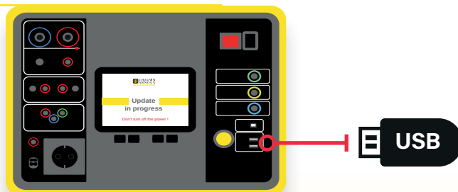
Aggiornamento Firmware tramite chiavetta USB
