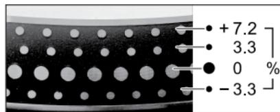
Per calibrare la velocità del disco, regolare il cursore del pitch in modo che lo strobo risulti fermo in corrispondenza della marcatura strobooscopica 0% del piatto.
