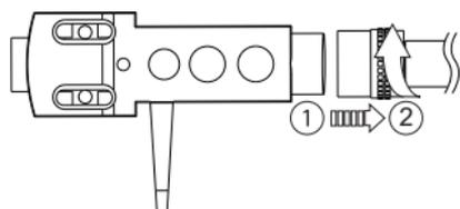
1. Allineare il connettore del portatestina con la presa del braccio di lettura.
