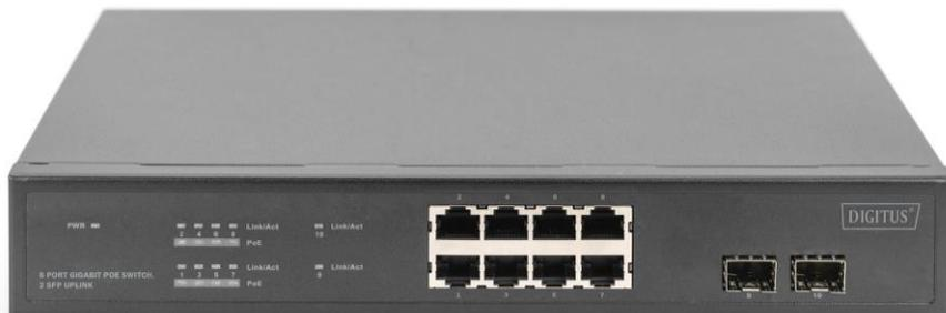
**LED ALIMENTAZIONE:** Il LED di alimentazione si accende quando lo switch è collegato a una fonte di alimentazione.
