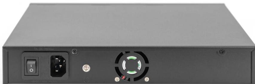
**Presa di alimentazione:** Supporta le tensioni in ingresso 100-240VAC, 50/60Hz.
