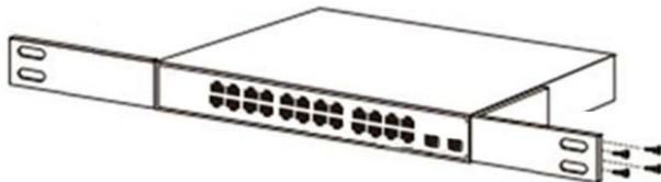
2. Utilizzare le viti fornite con il rack per montare lo Switch nel rack e stringerle.
