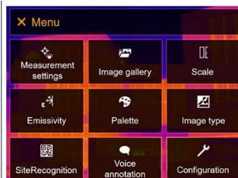
2 Selezionare **Emissività [Emissivity]** (con il joystick o il touchscreen).
