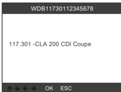
→ Questa ricerca legge il VIN (numero di identificazione del veicolo) e quindi riconosce automaticamente il modello del veicolo. Questa funzione attualmente supporta solo dai modelli Mercedes-Benz. I veicoli Smart e Sprinter devono essere selezionati manualmente.
