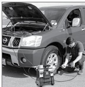
Batteria tramite cavi (CC)
