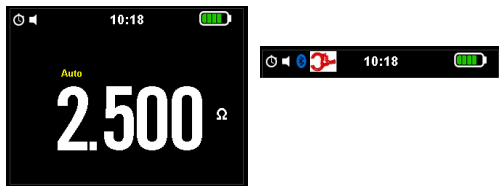
Illustrazione 3: Misurazione della resistenza di terra
