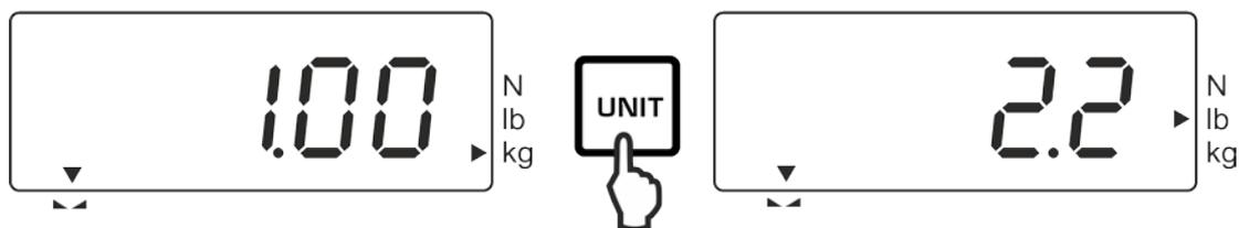
Ogni pressione del pulsante **UNIT** fa apparire sul display una successiva unità di misura **kg** → **lb** → **N**.
