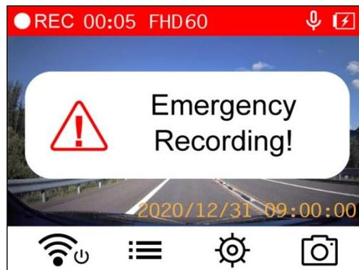
**Registrazione d'Emergenza con G-Sensor:** Durante la registrazione, la DrivePro attiverà automaticamente la registrazione d'emergenza quando rileverà una collisione..
