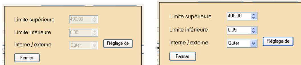
**Setup Enter** : lorsque l'on appuie sur ce bouton, il est possible de modifier la limite supérieure / inférieure et le mode ; lorsque le bouton n'est pas enfoncé, les réglages seront envoyés et enregistrés dans l'appareil.
