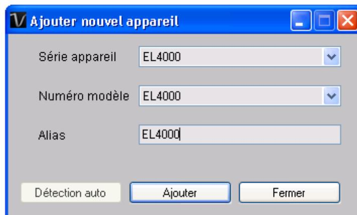
Sélectionner "EL4000" dans device series, "EL4000" dans model number, saisir un alias unique pour l'appareil et appuyer sur le bouton "Add".
