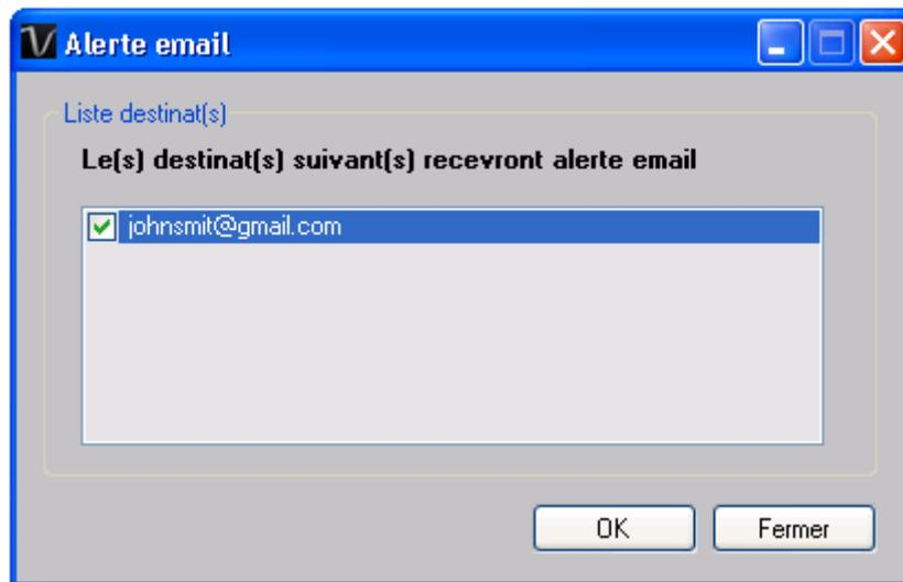
Etant donné que le SL451 soutient les mesures en temps réel, il dispose donc d'une fonction d'alerte par email qui enverra un email à l'utilisateur spécifié lorsque la mesure de l'appareil est supérieure ou inférieure à un certain niveau. Il est possible de configurer le niveau d'alerte dans Réglages.
