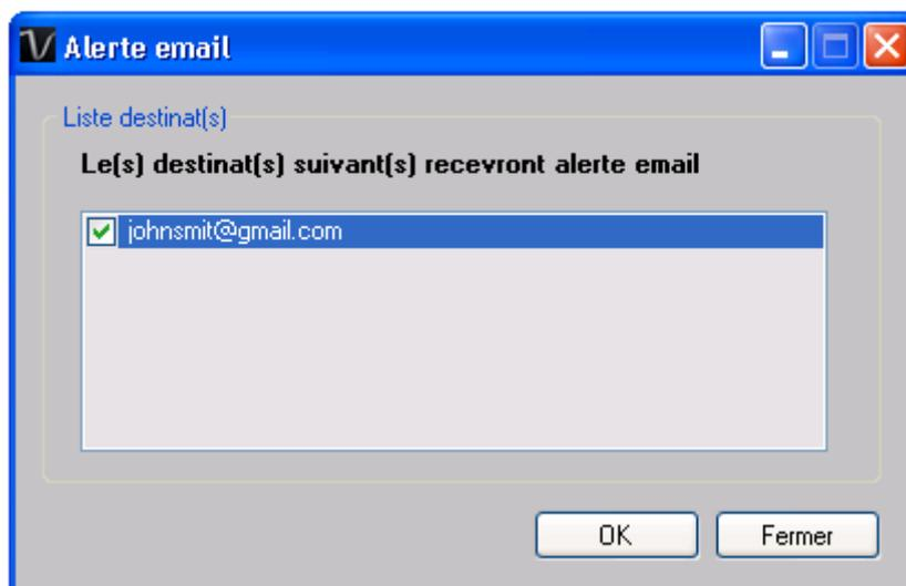
Etant donné que le DL161S soutient les mesures en temps réel, il dispose donc d'une fonction d'alerte par email, qui enverra un email à l'utilisateur spécifié lorsque la mesure de l'appareil est supérieure ou inférieure à un certain niveau. Il est possible de configurer le niveau d'alerte dans Réglages.
