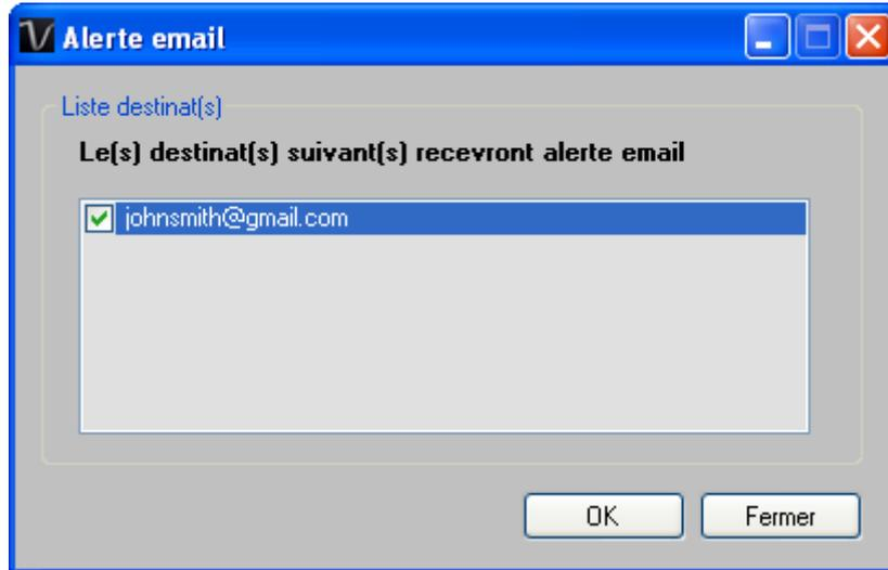
Voltsoft utilise une fonction d'alerte par email permettant d'envoyer un email à l'utilisateur spécifié lorsque la mesure du périphérique est supérieure ou inférieure à un niveau donné.
