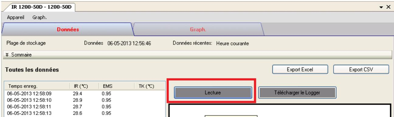
En mode temps réel, un appui sur la gâchette de l'appareil lancera l'envoi de données vers le PC; aucune donnée ne sera envoyée si l'on n'appuie pas sur la gâchette.
