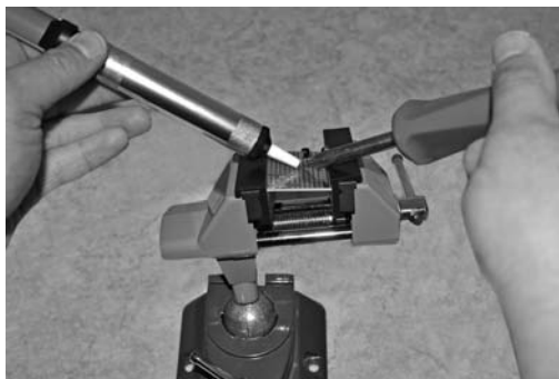
Bild 65: Das Auslöten funktioniert nur mithilfe der Entlötsaugpumpe.
