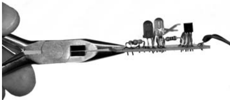
Bild 62: Die abgewickelten Anschlüsse sollten 0,5-1 mm über die Platine hinausragen.
