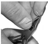
Bild 28: Der Draht wird mit einer Elektronikerrundzange zurechtgebogen.
