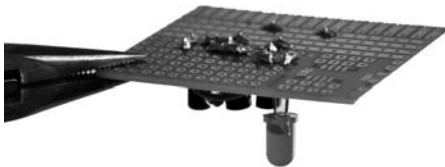
Bild 63: Anschlussdrähte sind knapp über den Lötkegeln abzuwickeln.
