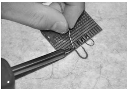
Bild 30: Anlöten von Drahtbrücken am seitlichen Streifenraster
