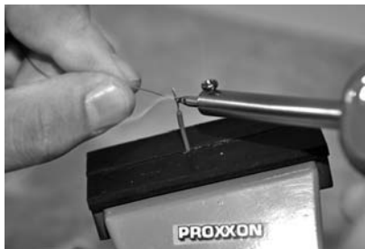
Bild 26: Der verdrillte Draht ist zu erhitzen und etwas Lot zuzuführen, das sofort schmilzt.
