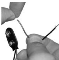
Bild 25: Zuerst sind die Litzen mit den Fingern zu verdrillen.
